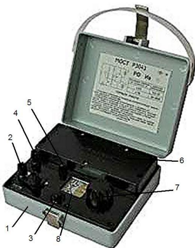
Рис. 13.16. Міст переносний постійного струму Р 3043:
