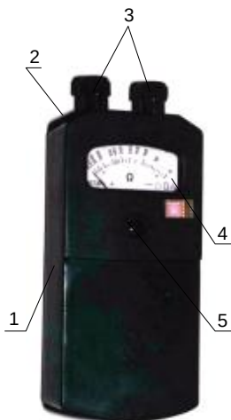
Рис.13.17. Малий омметр М-57:
