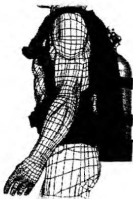
**Рис. 5.32. Повітряна камера системи плавучості Zeagle**
