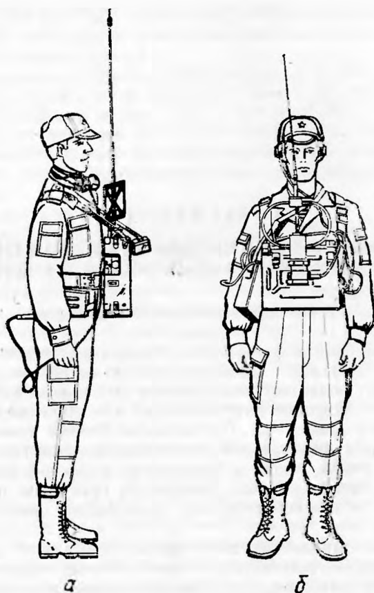
Рис. 16. Станции радиоразведки, развернутые для работы в движении: а — станция Р-396У; б — станция Р-396 2К
