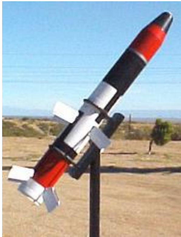
Рисунок 3.16. – 155-мм високоточний снаряд M712 Copperhead
