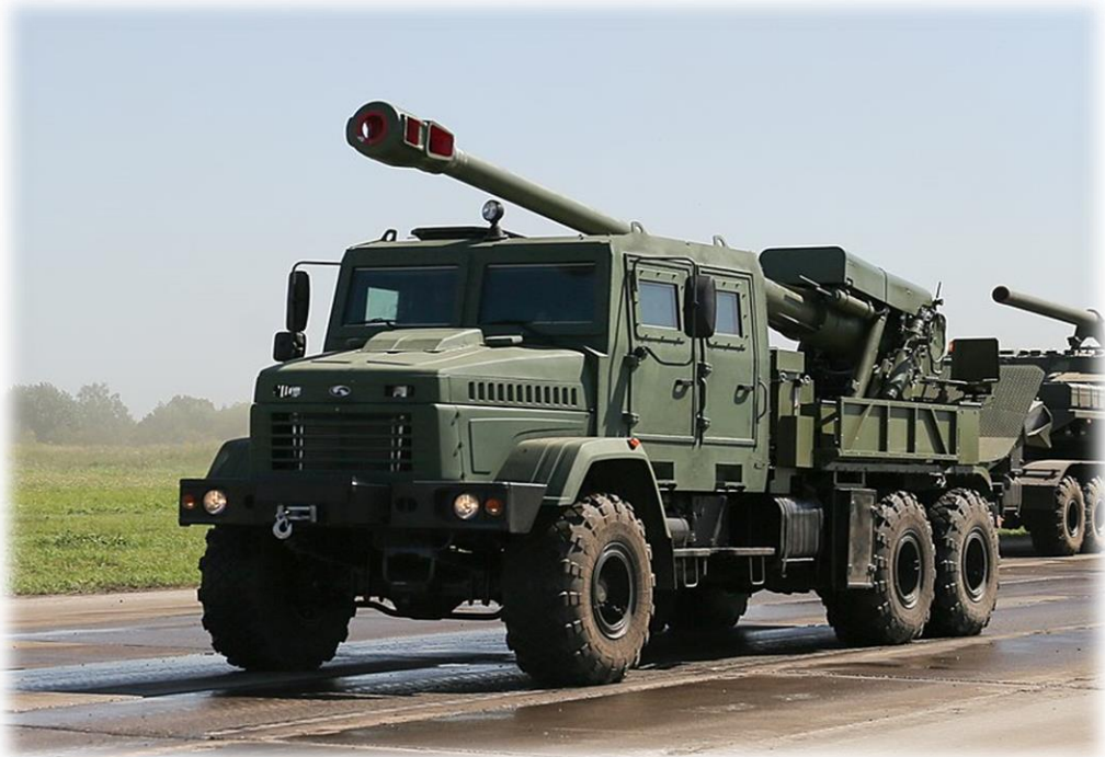
Рисунок 2.5. – Самохідна артилерійська установка БОГДАНА
