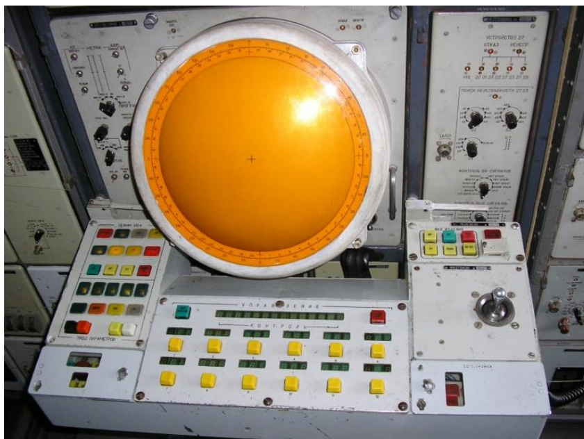
Рисунок 14 – вигляд індикатора РЛС 9С18М1.
